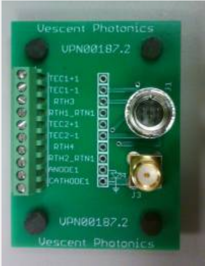
Fig. 1: D2-007 Breako ut board.
